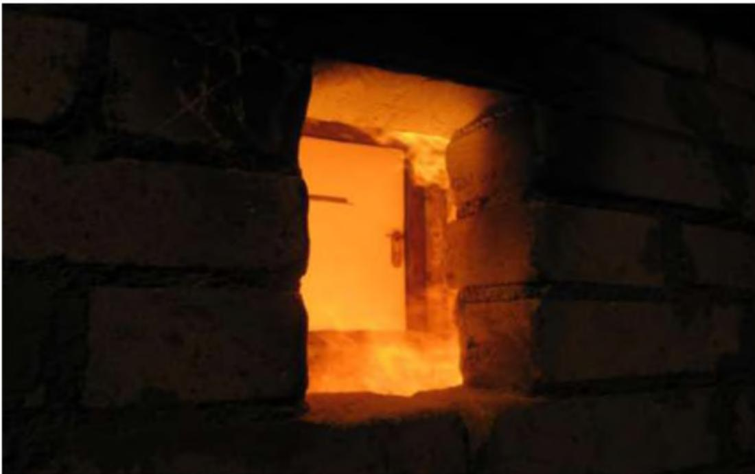
Огневые испытания противопожарных люков (93 минута).
